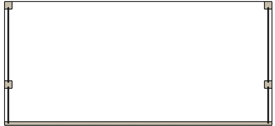
Nuten Rückwand (Ansicht von Vorne)
